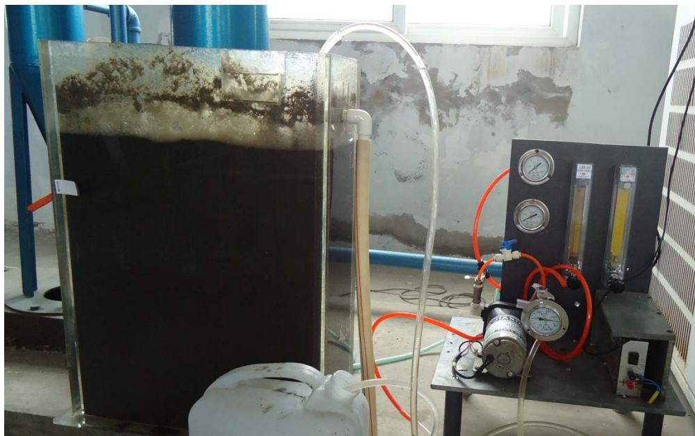
Πρωτότυπο MBR (βυθιζόμενες μεμβράνες επίπεδων φύλλων) με σύστημα εξαγωγής διηθήματος.
